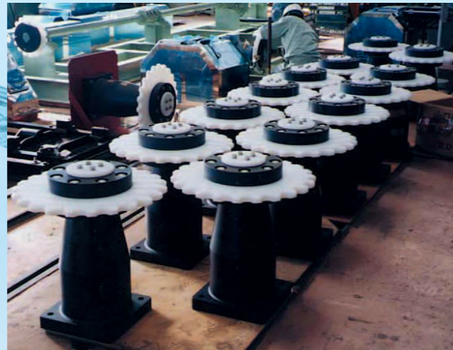
樹脂製汚泥かき寄せ機用軸受及びスプロケット
